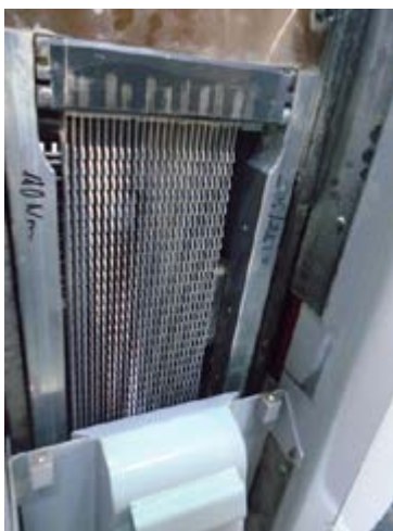
Obr. 42 – Speciální rámová pila pro pořez tužkárenských prkének
