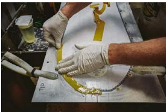
Obr. 19 – Připevnění ocelové hrany (firma Burton)
