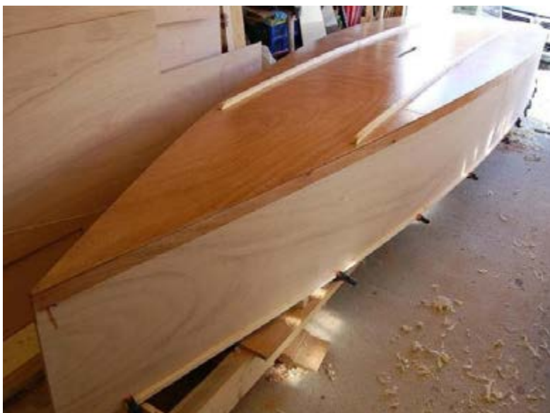
Obr. 33 – Loď s konstrukčními prvky z překližované desky
