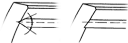
Obr. 1 – Propustné osazení víka dřevěného sudu
