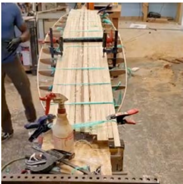
Obr. 28 – Tvorba konstrukce paddleboardu
