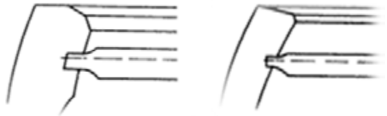
Obr. 2 – Nepropustné osazení víka dřevěného sudu
