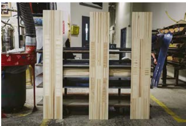
Obr. 18 – Sesazené dřevěné bloky pro výrobu jádra (firma Burton)
