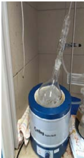
Obrázek 14 Stanovení Klasonova ligninu [51]
