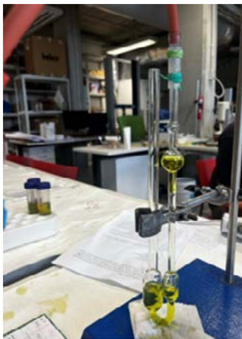
Obrázek 9 Měření polymeračního stupně pomocí Ubbelohdeho viskozimetru [36]
