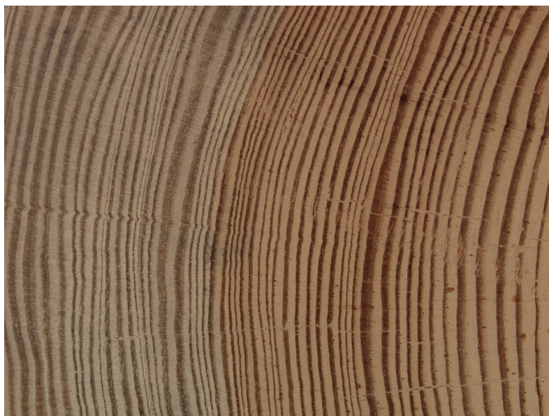
Obr. 23: Rozdílná šířka letokruhů, odlišný podíl letního dřeva v letokruhu, nebo přítomnost různě zbarvených zón v kmeni patří k ukázce heterogenity stavby dřeva.
