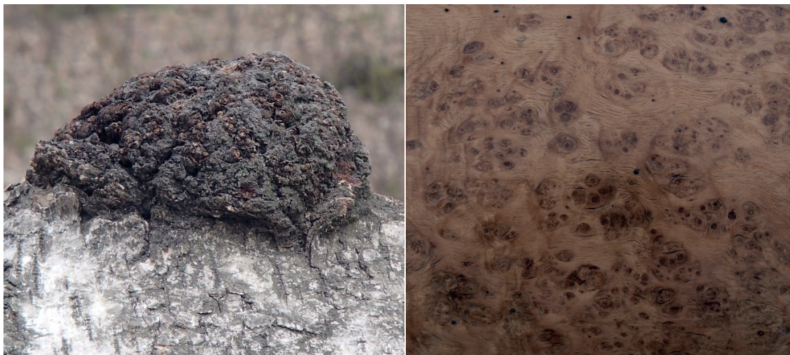
Obr. 26: A – Boulovitost patří k vadám tvaru kmene, které omezují možnosti pilařského zpracování a využití řeziva v konstrukcích. B – Boule jsou díky své originální textuře dřeva cíleně vyhledávány při výrobě dých.
