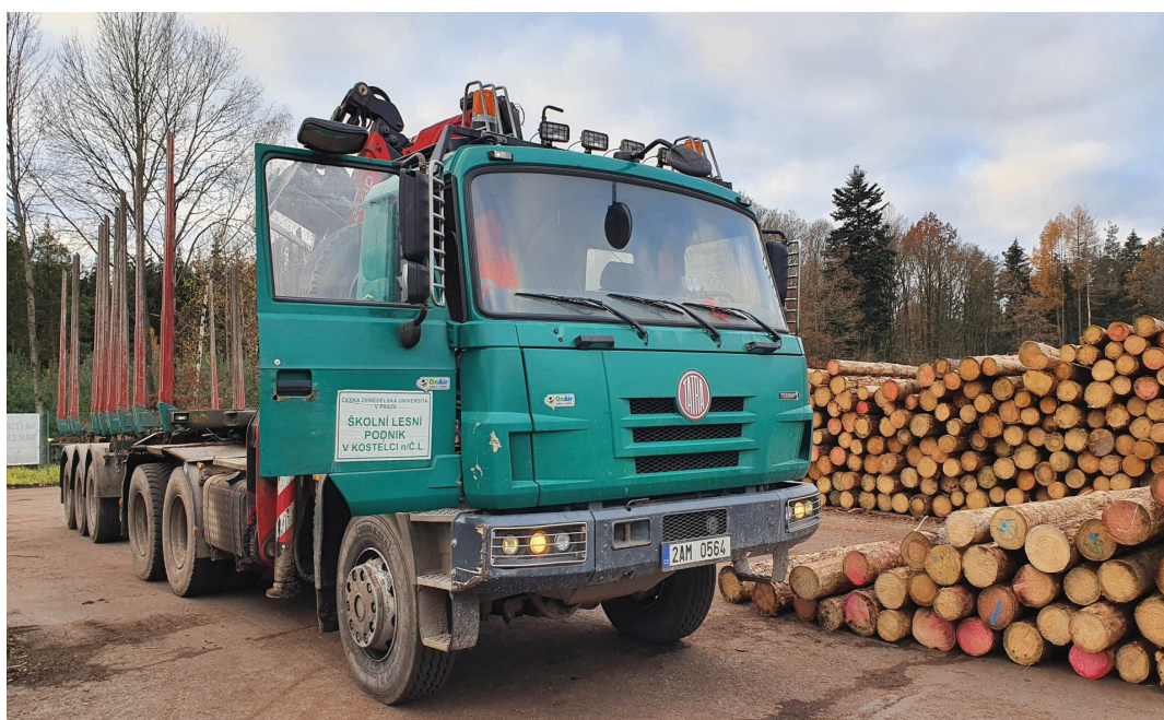
Obrázek č. 46: Odvozní souprava – Tatra 815 s jeřábem a teleskopický návěs Umikov
