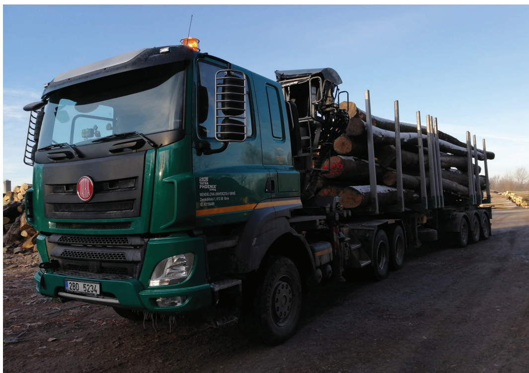
Obrázek č. 48: Odvozní souprava – Tatra Phoenix s jeřábem a teleskopický návěs Umikov s automatickou váhou řízeným přitlakem náprav návěsu
