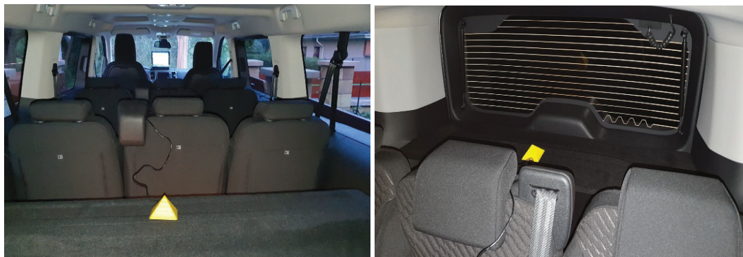
Obrázek č. 27: Umístění přijímací pyramidy: uvnitř vozidla za poslední řadou sedadel
