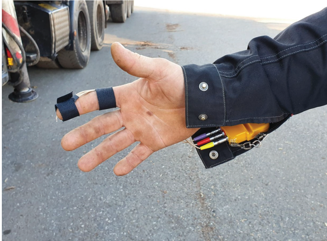
Obrázek č. 51: Upevnění senzoru MULTI modulu na posledním článku 2. prstu řidiče
