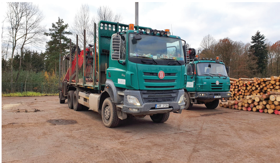
Obrázek č. 47: Odvozní souprava – Tatra Phoenix s plošinou a klanicemi s jeřábem a přívěs s klanicemi Lemex
