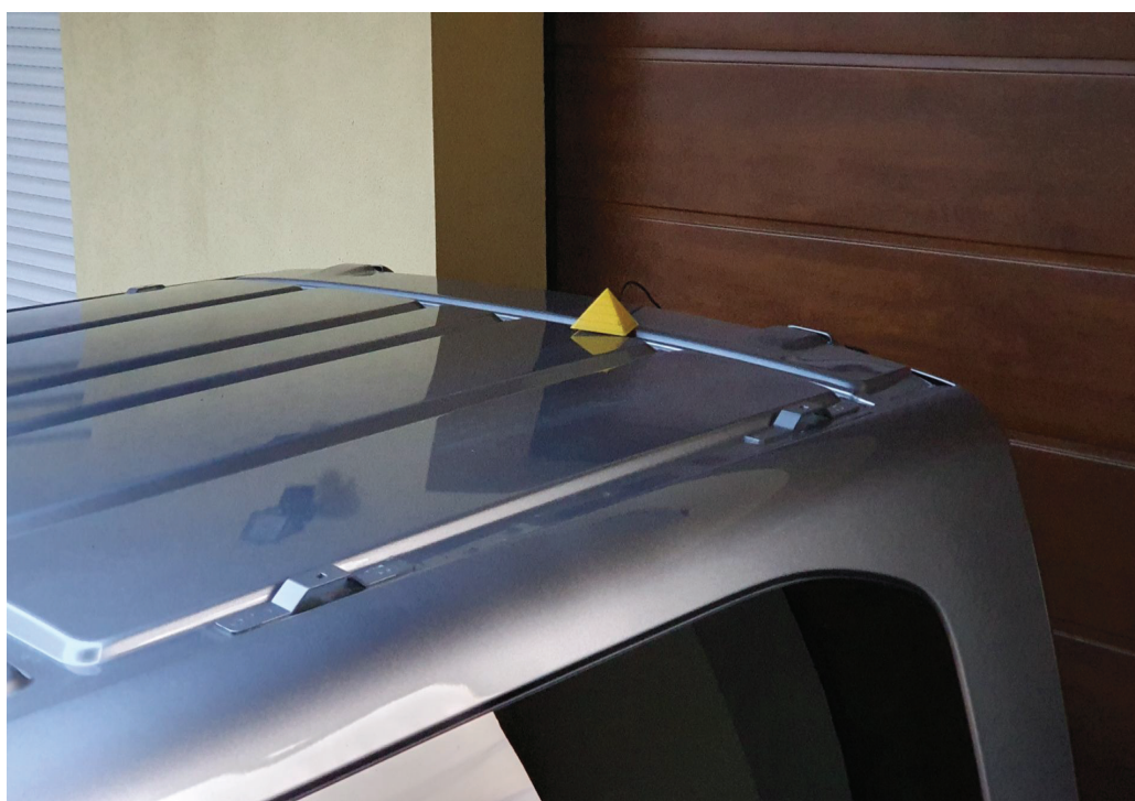
Obrázek č. 25: Exterier vozidla, vysílač umístěný na střeše vozidla
