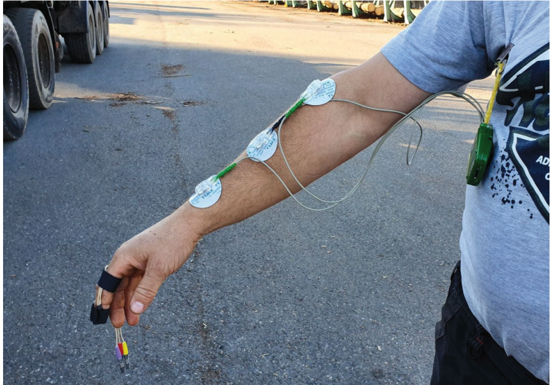
Obrázek č. 52: Upevnění elektrod modulu EMG na pravém předloktí řidiče
