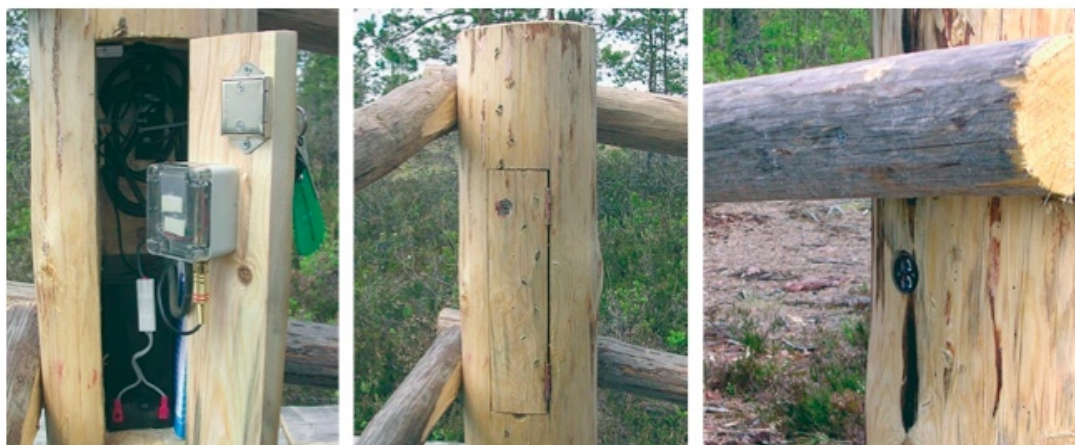
Obrázek č. 2: Ukázka instalace elektronického sčítače návštěvníků v lesích Finska
