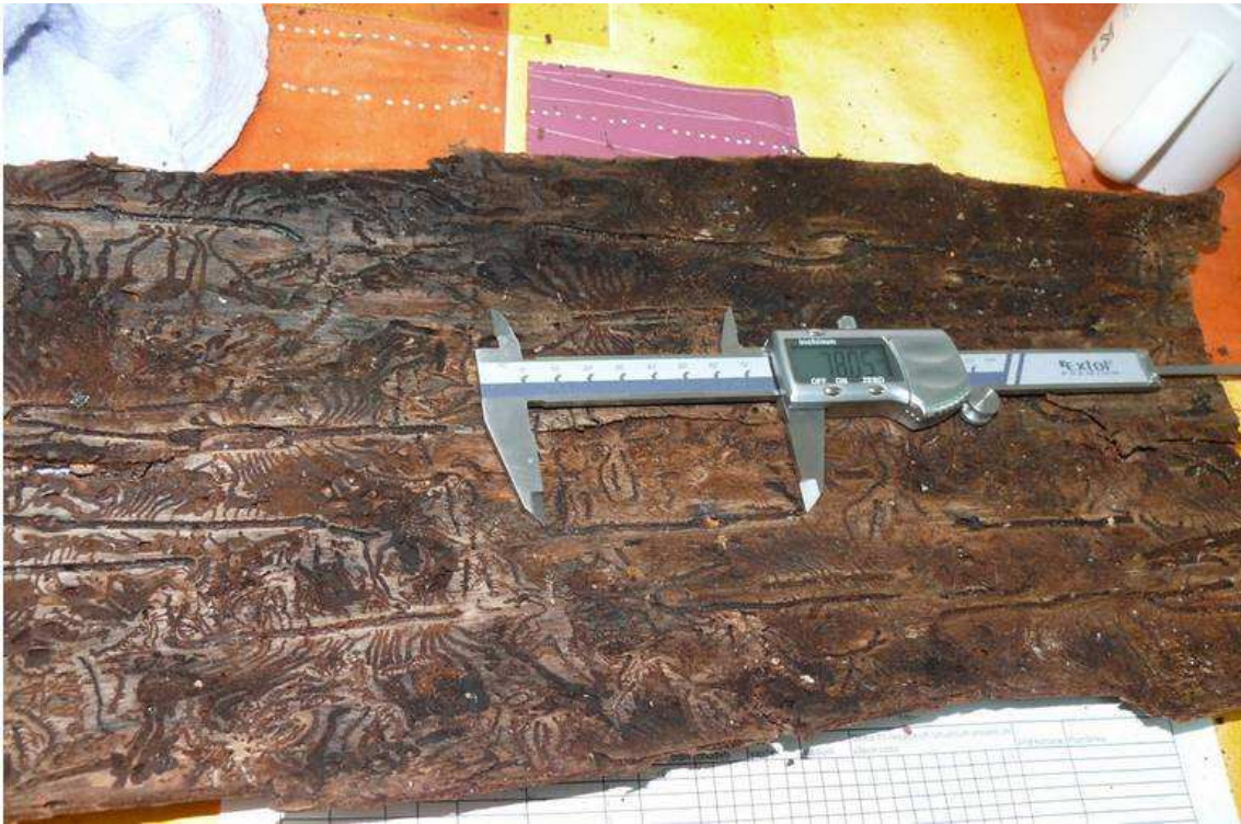
Obr. 104 Zjišťování počtu a délek chodeb v kanceláři
