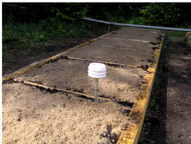
Obr. č. 23: Čidlo snímající teplotu ve 30 cm nad povrchem výsevové plochy
