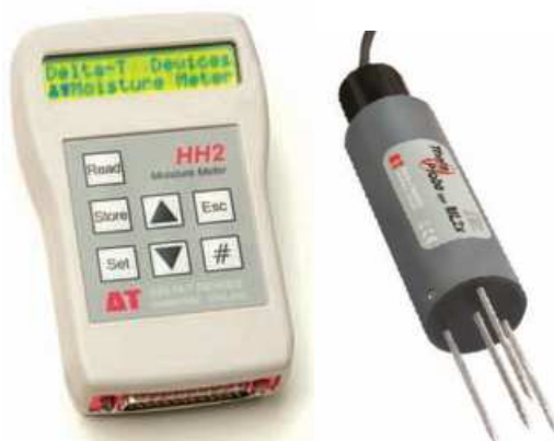
Obr. 7: HH2 Moisture Meter se sondou ML2x.
