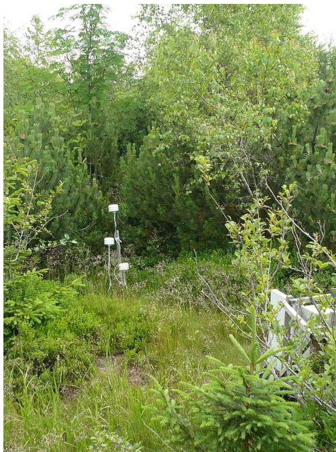
Obr. 20: Umístění teplotních čidel ve výškovém gradientu na VP Lesní bouda.
