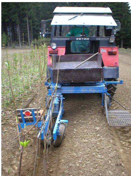
Obr. č. 21. a č. 22.: Školkovací stroj vyvinutý a zkonstruovaný v lesních školkách Burda v letech 2000-2001
