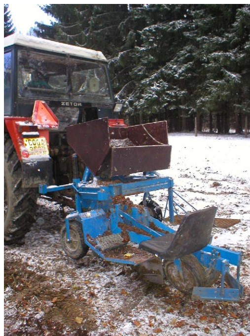
Obr. č. 21. a č. 22.: Školkovací stroj vyvinutý a zkonstruovaný v lesních školkách Burda v letech 2000-2001
