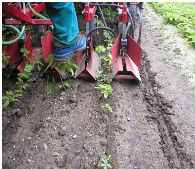
Obr. č. 13.: Nasazení meziřádkové chemické plečky firmy EGEDAL (LS Orlík nad Vltavou)
