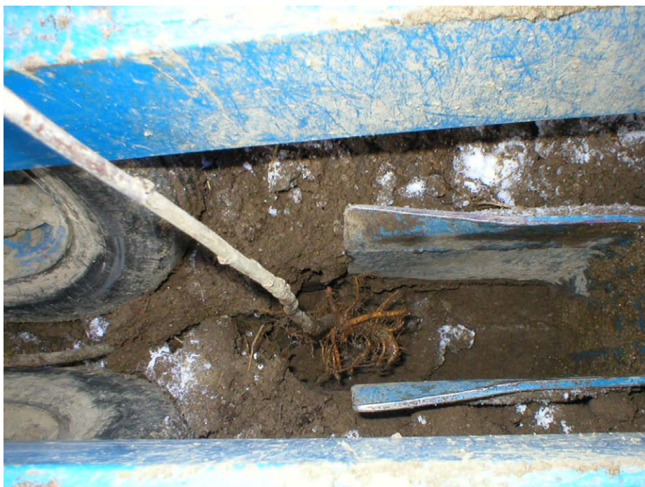
Obr. č. 56.: Ukázka vkládání rostliny do školkovacího ústrojí – školka „Růžená“ podzim 2006
