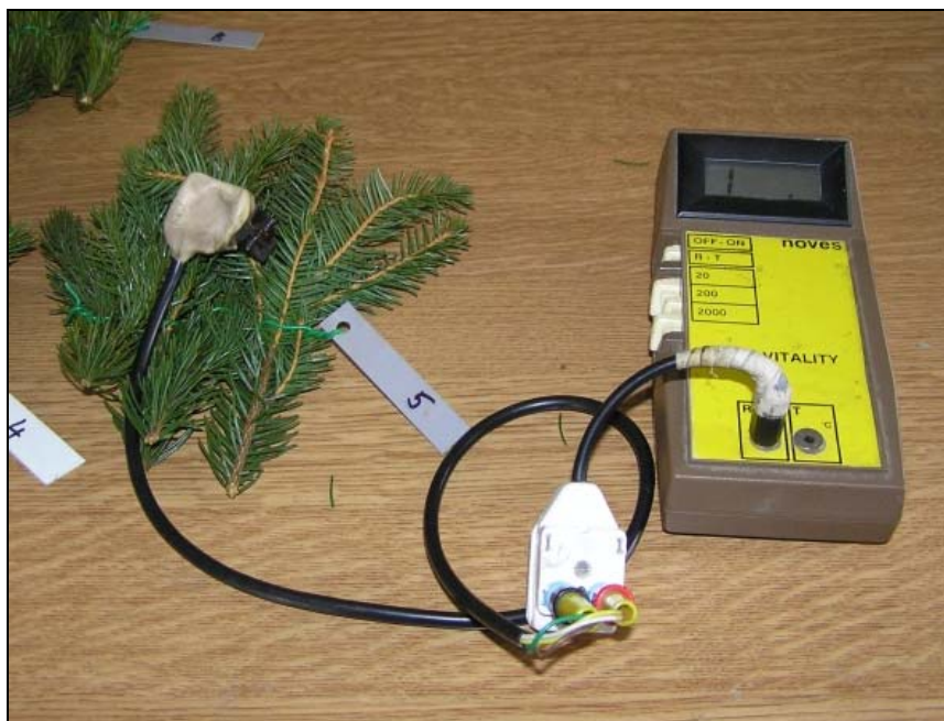
Obr. 7: Měření elektrického odporu smrkových větviček pro hodnocení odolnosti k mrazu
