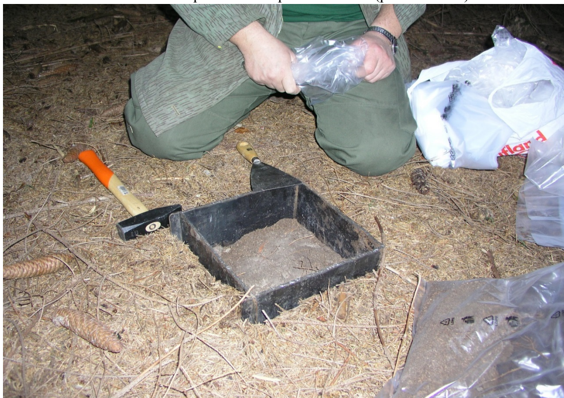
Obr. 9.2.2: Odběr humusových horizontů pomocí kovových rámečků 25 × 25 cm
