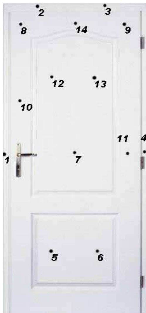
Obr. 5 Schéma rozmístění termoelektrických článků na ploše dveřního křídla
