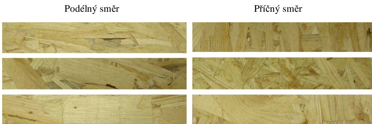
Obrázek 5-19: Příklady zkušebních těles OSB/3 – Superfinish
