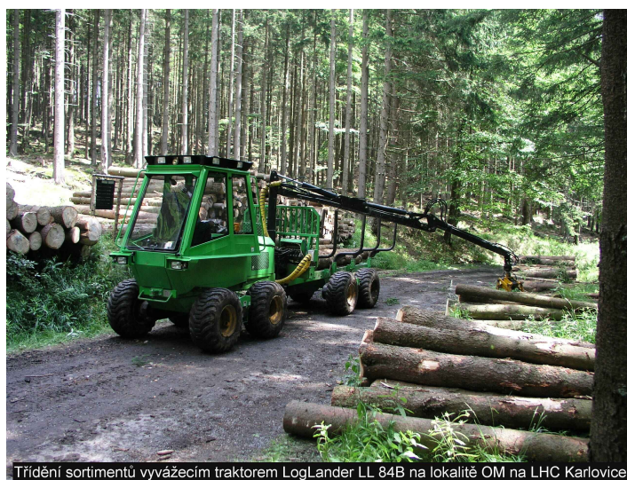
Třídění sortimentů vyvážecím traktorem LogLander LL 84B na lokalitě OM na LHC Karlovice
