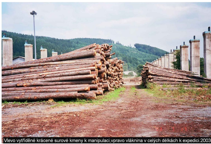
Vlevo vytříděné krácené surové kmene k manipulaci, vpravo vláknina v celých délkách k expedici. 2003
