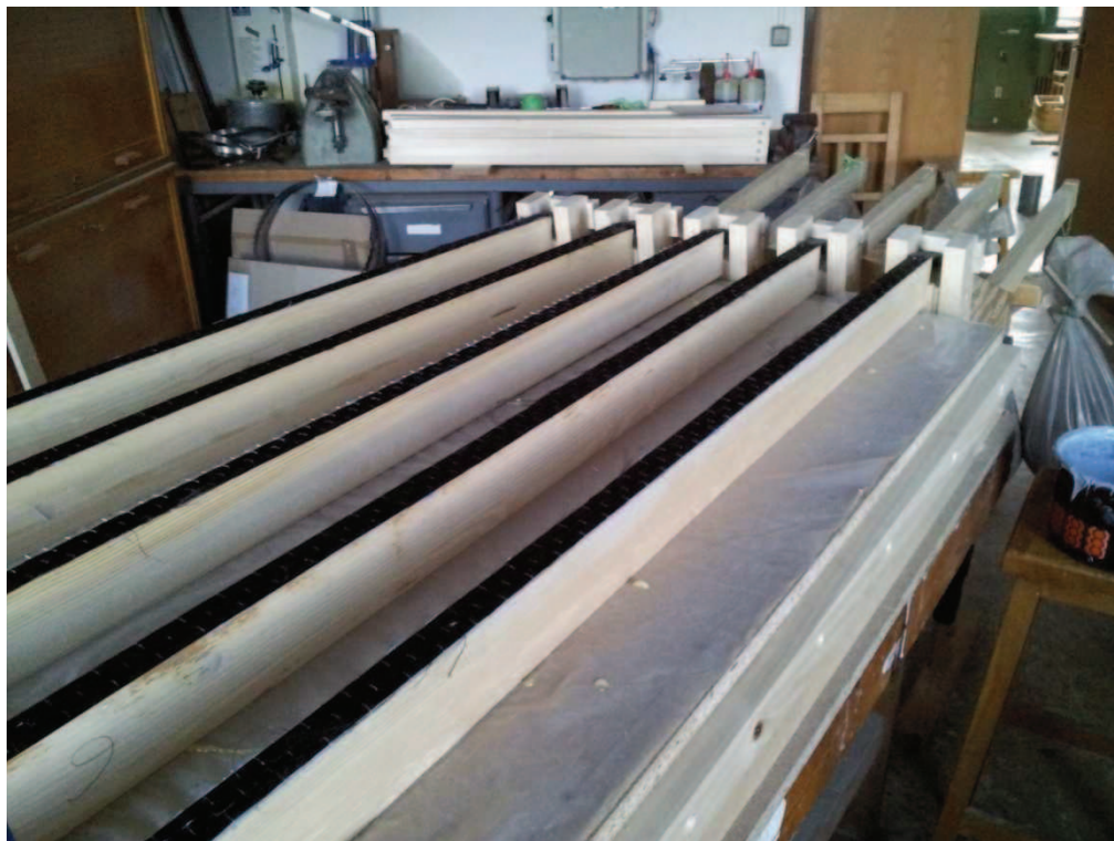
Předeprtá a přilepená uhlíková tkanina epoxidovým adhezivem
