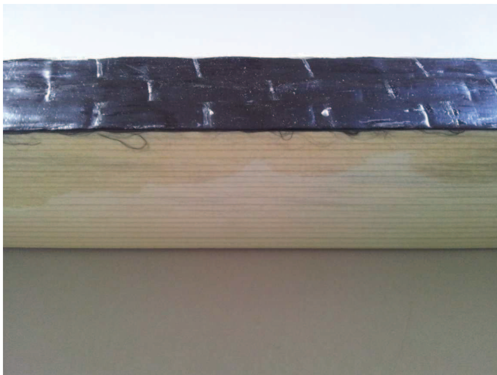
Přilepená uhlíková tkanina epoxidovým adhezivem
