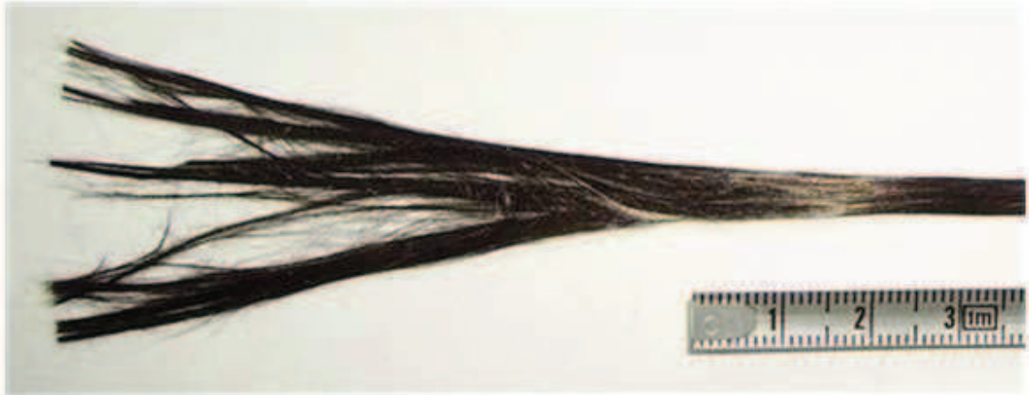
Obr. 10 Pásek vláken ve formě rovingu (PRINCE ENGINEERING, 2011)
