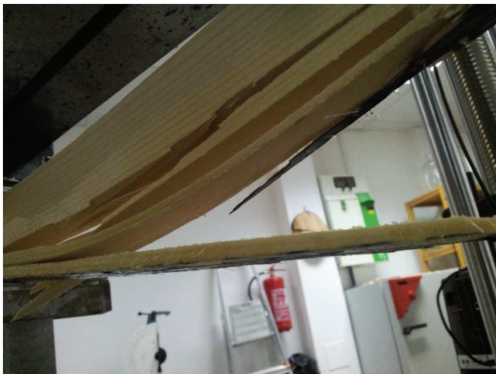
Porušení v tažené zóně nosníku vyztuženého uhlíkovou tkaninou s použitím polyuretanového adheziva
