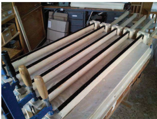
Obr. 16 Předepnutí uhlíkových tkanin na dřevěných nosnících
