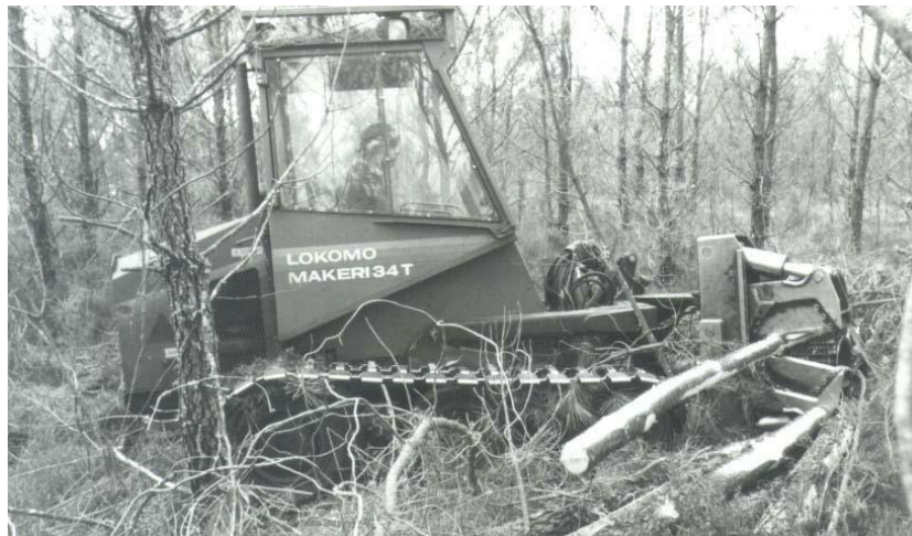
Obr. 2. Jeden z prvních harvestorů Lokomo Makeri 34T s kácecími nůžkami (Laurier et al., 2003)
