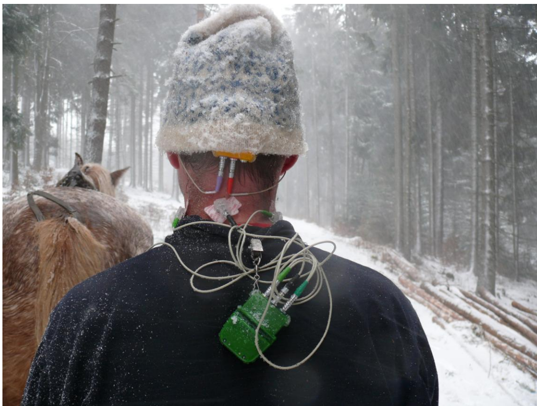
Obr. 14. Instalace snímačů BFB v lesním prostředí při přibližování dříví koněm (zdroj: archiv autora)
