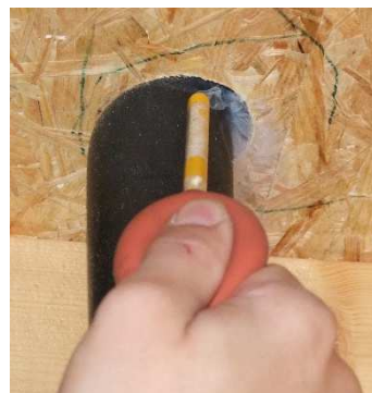
Obrázek 39 Kouřová trubice KT1.
