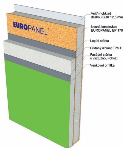
Obrázek 16 Schéma SIPs panelu. [62]
