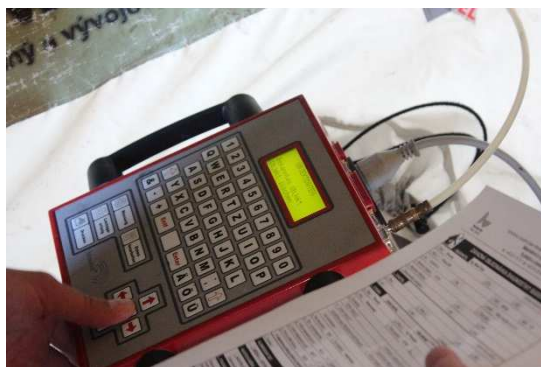
Obrázek 49 Výpočetní jednotka Blowtest 3000.
