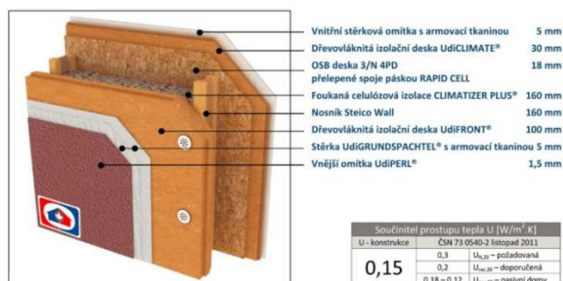
Obrázek 20 Příklad difúzně otevřené skladby. [51]
