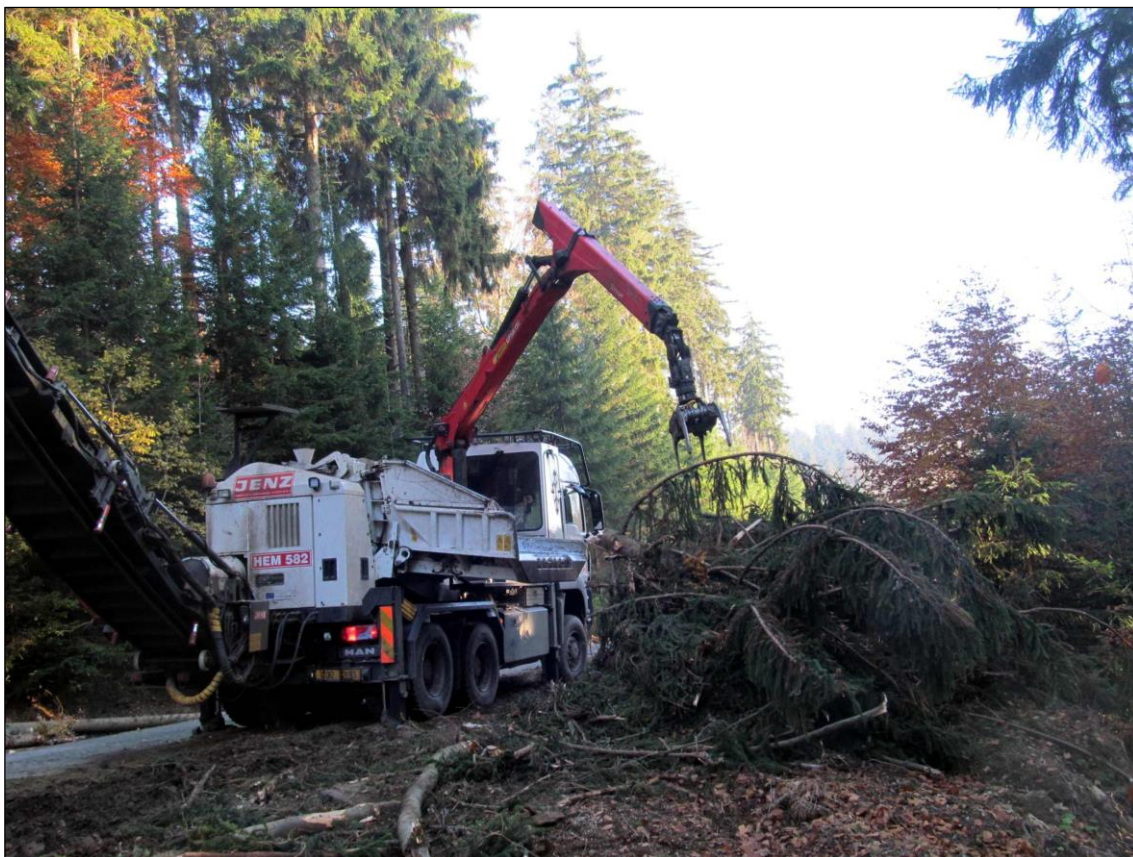
Obrázek 4: Štěpkovač Jenz HEM 582 - nástavba na nákladním automobilu
