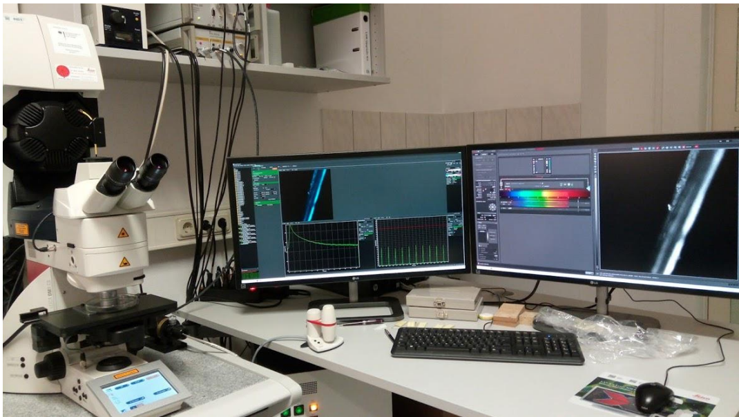
Příloha 12 Sestava laserového konfokálního mikroskopu pro fluorescenční časovou zobrazovací mikroskopii
