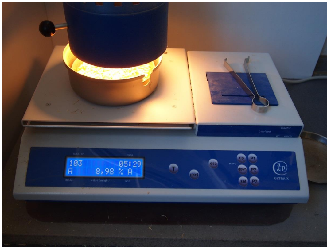
Příloha 3 Přesné zjišťování vlhkosti třísek po aplikaci adhesiva pomocí přístroje Ultra X
