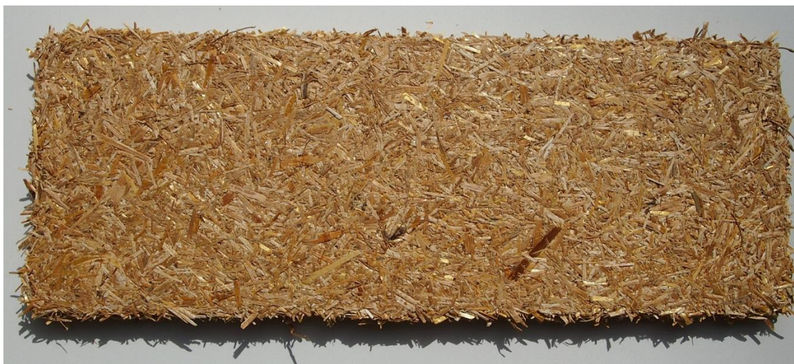
Příloha 7 Vylisovaná deska ze slámy pšenice ozimé
