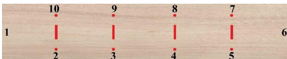
Obrázek 4.10: Značení míst měření (tečky pro měření barvy a lesku, čárky pro drsnost) (Oberhofnerová)
