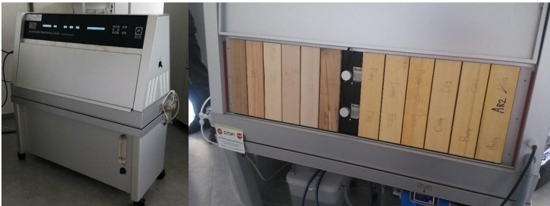
Obrázek 4.7: Testování v QUV komoře (foto Oberhofnerová)
