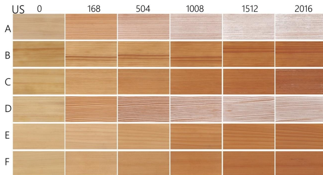
Obrázek 5.24: Vizuální podoba nátěrových systémů (A-F) během umělého stárnutí US (po 0,168,504,1008,1512 a 2016 hodinách)
