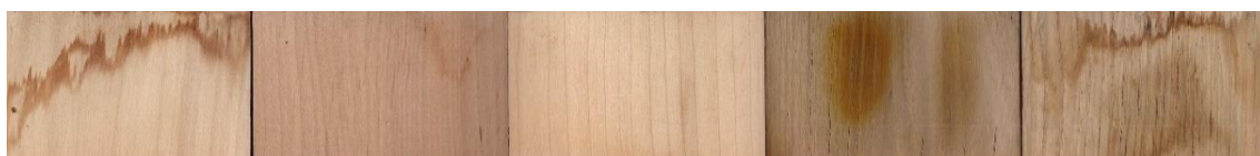
Obrázek 3.9: TP, OL, JV, AK, DB po 12 týdnech v UV komoře – vyplavování extraktiv (Oberhofnerová)
