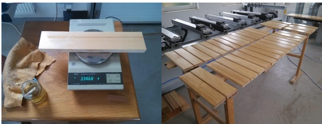
Obrázek 4.5: Příprava zkušebních těles – aplikace nátěrů (foto Oberhofnerová)
