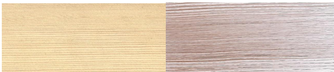
Obrázek 3.4: Smrk bez nátěru vystavený zkoušce umělým povětrnostním stárnutím; před expozicí (vlevo) a po 12 týdnech expozice (vpravo); viditelné výrazné zesvětlení dřeva vyplavováním degradovaného ligninu a vzniku plastické struktury (foto Oberhofnerová)
