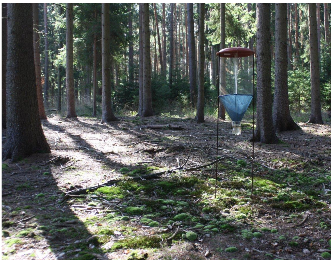
Obrázek 4. Ukázka nárazové pasti ve smrkovém porostu
