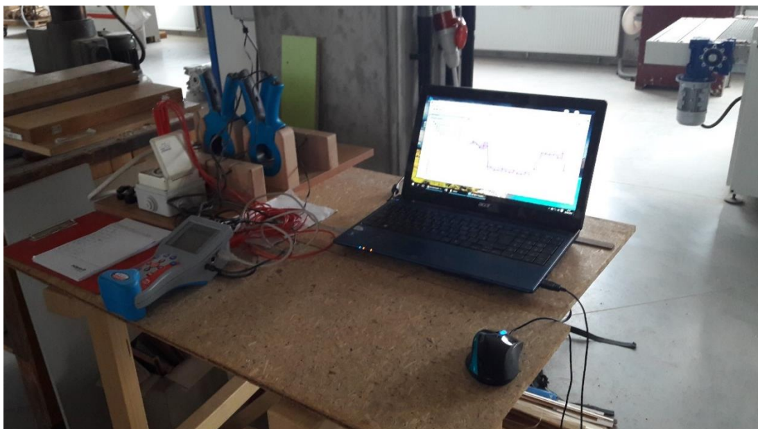
Obr. 30. Používaný přístroj METREL Power Q plus MI2392
