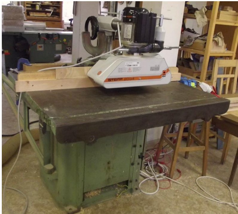
Obr. 27. Ukázka jednovřetenové spodní frézky typu FVS
