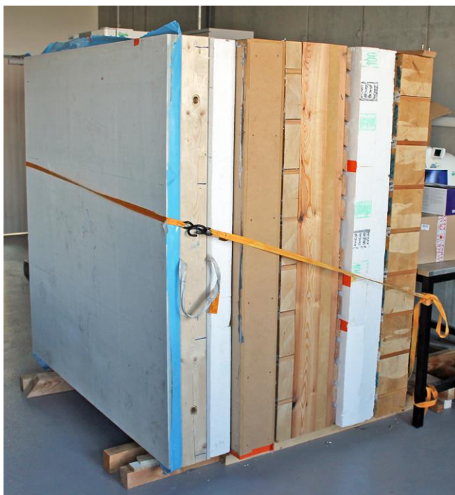
Obrázek 24: Kondicionování panelů v laboratoři s řízenou teplotou a vlhkostí vzduchu
