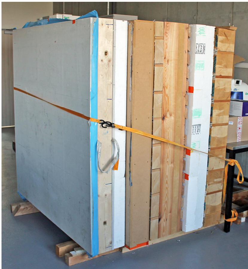
Příloha 24: Kondicionování stěnových panelů v laboratoři
