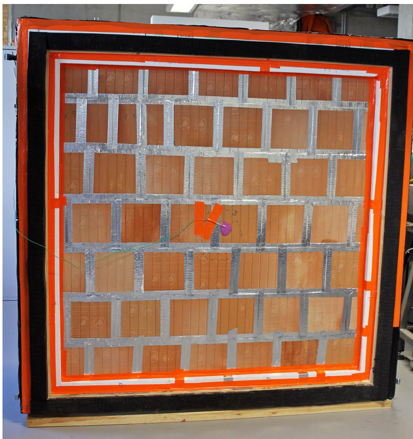
Příloha 23: Panel z keramických tvárnic Porotherm (ozn. 9)
