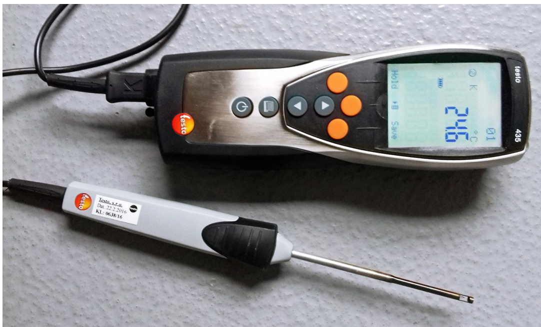
Příloha 11: Měřicí přístroj - Multifunkční měřicí přístroj Testo 435 s teplotní sondou pro kontrolní měření teploty vzduchu v laboratoři
