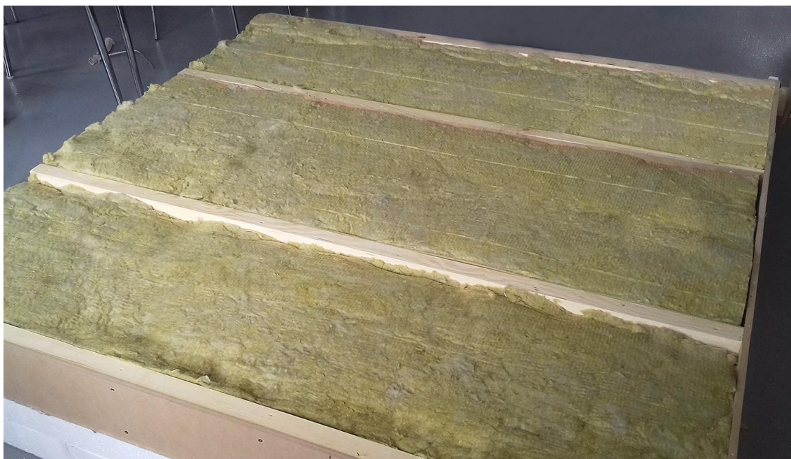
Příloha 19: Panel na bázi dřeva s izolační výplní z minerální vlny (ozn. 4)
