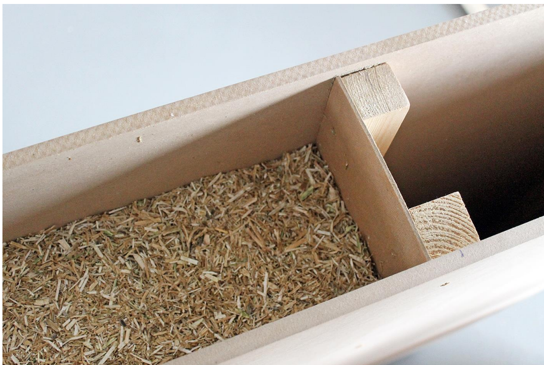
Příloha 17: Panel na bázi dřeva s izolační výplní z řepkové řezanky (ozn. 2)
