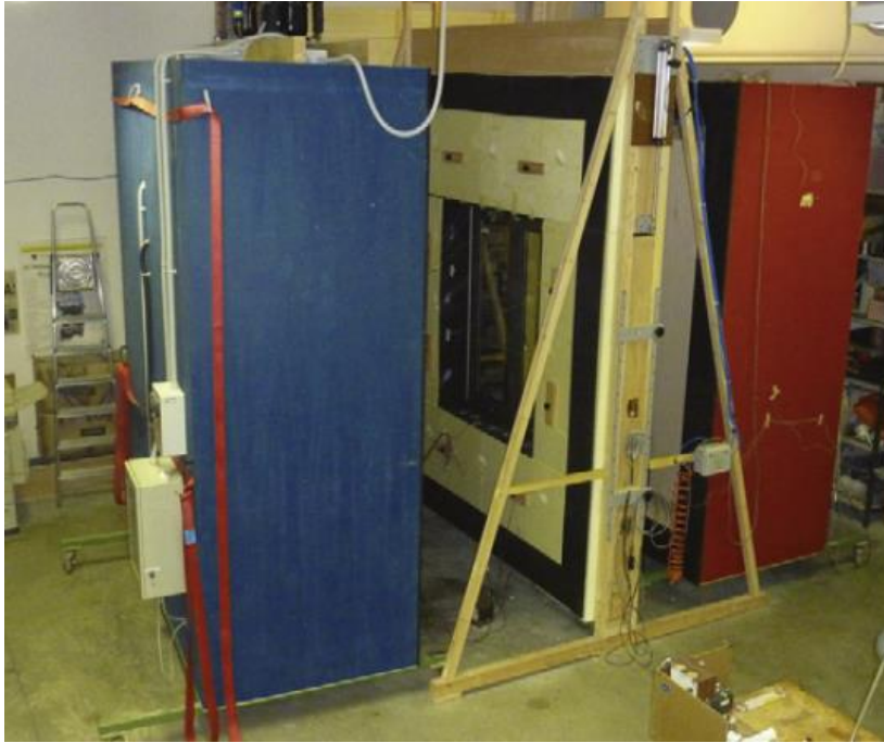
Obrázek 13: Experimentální zařízení teplé skříně; mezi chladnou komorou (vlevo) a teplou komorou (vpravo) je umístěn testovaný vzorek (Asdrubali & Baldinelli, 2011)
