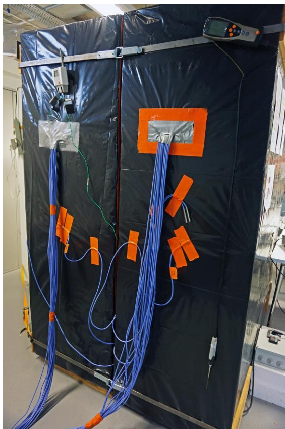
Příloha 7: Teplá skřín z boku po osazení testovaného panelu a uzavření obou komor ocelovými pásky; vpravo teplá komora, vlevo chladná komota
