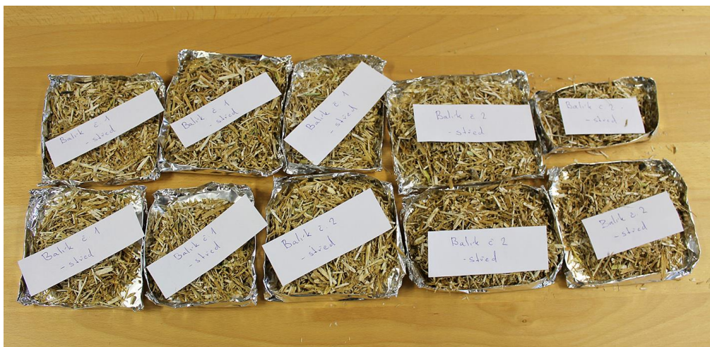
Příloha 14: Příprava vzorků na měření obsahu vlhkosti u izolačních výplní (ozn. 1-4), na obrázku řepková řezanka
