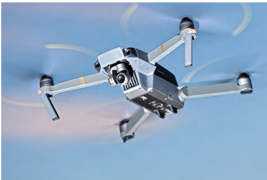
Dron DJI MAVIC 2 Enterprise vybavený termokamerou FLIR One, který pro vyhledávání srnčat používají pracovníci univerzity.
