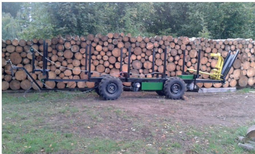
Projekt s názvem Elektrický vyvážecí stroj byl řešen v letech 2017–2018 v rámci projektu TA ČR Gama s cílem vytvořit vhodný stroj pro vyvázení slabšího dříví v lesních porostech a z plantáží rychle rostoucích dřevin.
