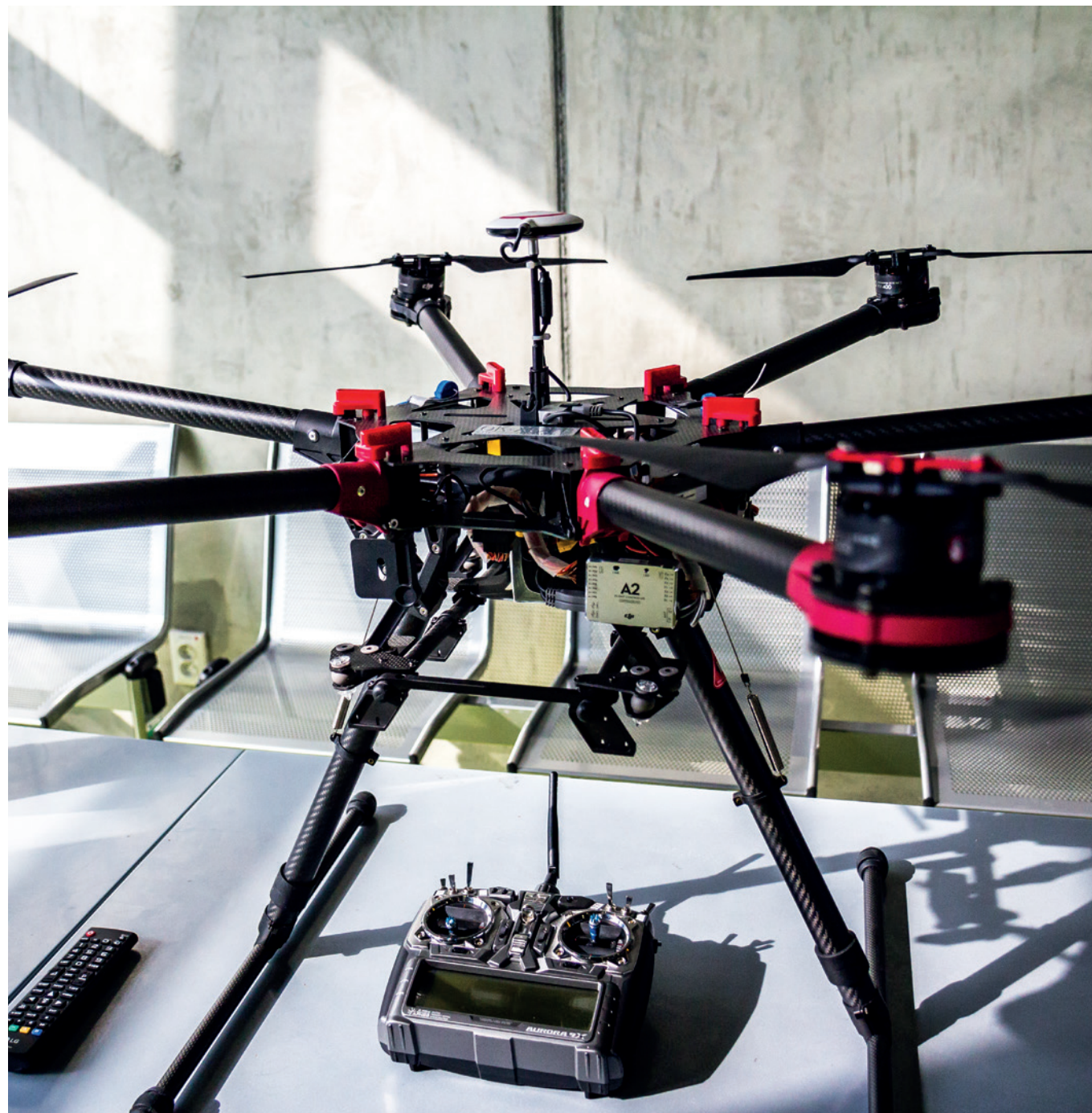
Dron vybavený hyperspektrálním skenerem připravený k letu pro sledování časové změny zdravotního stavu porostu včetně provozního příslušenství (baterie, počítač).
