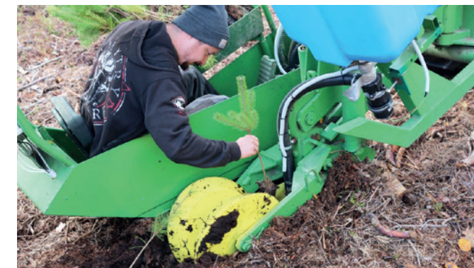
Obr. 1 a 2: Rýhovací stroj s dávkovacím zařízením hydrogelu v terénu.
